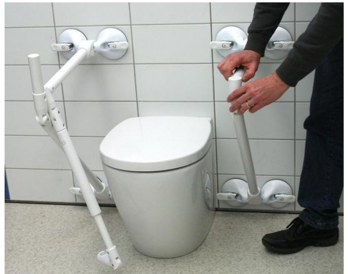
Griff zerlegen und kurzen Verbinder gegen den langen Verbinder austauschen und die Winkelgenkaufnahme wie auf der anderen Seite einstecken
