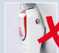
Wird der rote Seitenrand der Sicherheitswippe sichtbar muss der Haltegriff gelöst und erneut angebracht werden. Das Prinzip: Bei Vakuumverlust fährt die Sicherheitswippe aus. Es besteht zwar noch eine reduzierte Haltekraft, aber der Griff erreicht nicht mehr die im maximalen Benutzergewicht angegebene Haltekraft. Also einfach den Haltegriff lösen und neu fixieren.
