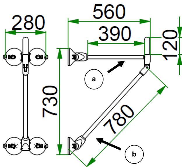
Durch das Mobeli Baukastensystem kann das zusätzliche Griffhorn von 120 mm auch nachträglich angebracht werden.
