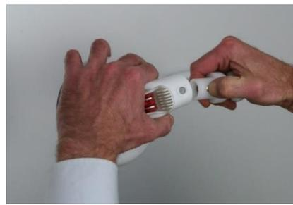
Schnellverriegler des Teleskopgriffes eindrücken und in den Kardangelenkadapter stecken.
