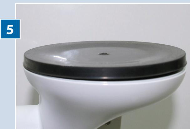
Wenn ein Haltegriff für längere Zeit an einer porrendichten Oberfläche befestigt ist, wird die Gummischeibe des Saugkopfes überdehnt und leicht gewölbt (**Bild 5**). Daher empfehlen wir, den Griff etwa alle 14 Tage von der Oberfläche zu lösen und über Nacht mit entspannten Kipphebeln auf einer ebenen Fläche liegen zu lassen.
