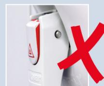
Wird der rote Seitenrand der Sicherheitswippe sichtbar muss der Haltegriff gelöst und erneut angebracht werden. Das Prinzip: Bei Vakuumverlust fährt die Sicherheitswippe aus. Es besteht zwar noch eine reduzierte Haltekraft, aber der Griff erreicht nicht mehr die im maximalen Benutzergewicht angegebene Haltekraft. Also einfach den Haltegriff lösen und neu fixieren.
